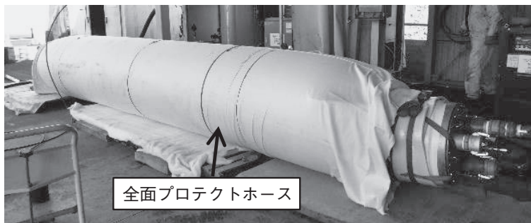
写真3 手順① 試験状況 (オールライナー+全面プロテクトホース)
