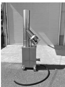
写真-1 排気拡散装置外観
