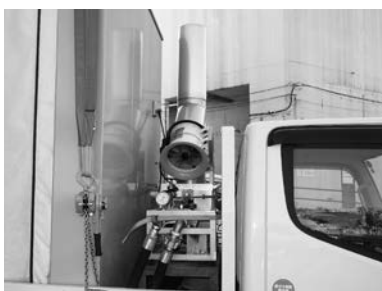
写真-2 排気拡散装置の装着状況
