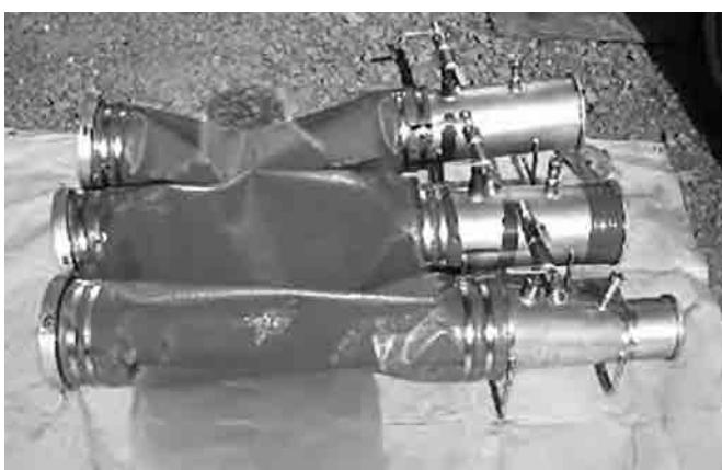
写真-2 現在使用している治具 (圧力管理も難しい)
