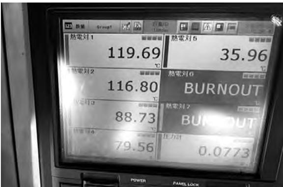
高温・短時間で行う蒸気施工における養生工
