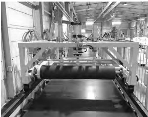
写真-4 可動式含浸ローラを備えた新設備
