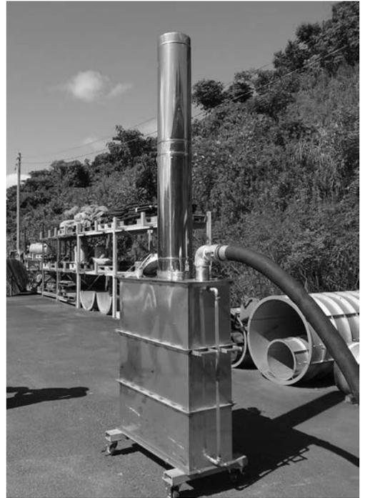
写真-5 蒸気の温度調整を行う蒸気ミキサー
