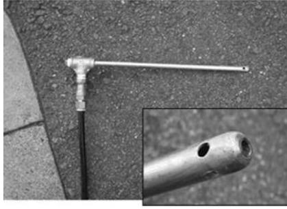
写真-5 ドレン除去具(ノズル全体および先端部拡大)
