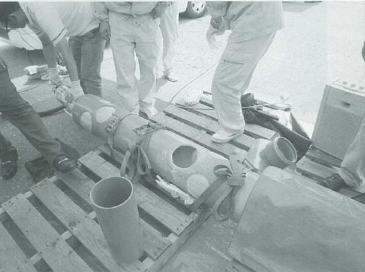
図-1 取付け管穿孔の基準①
