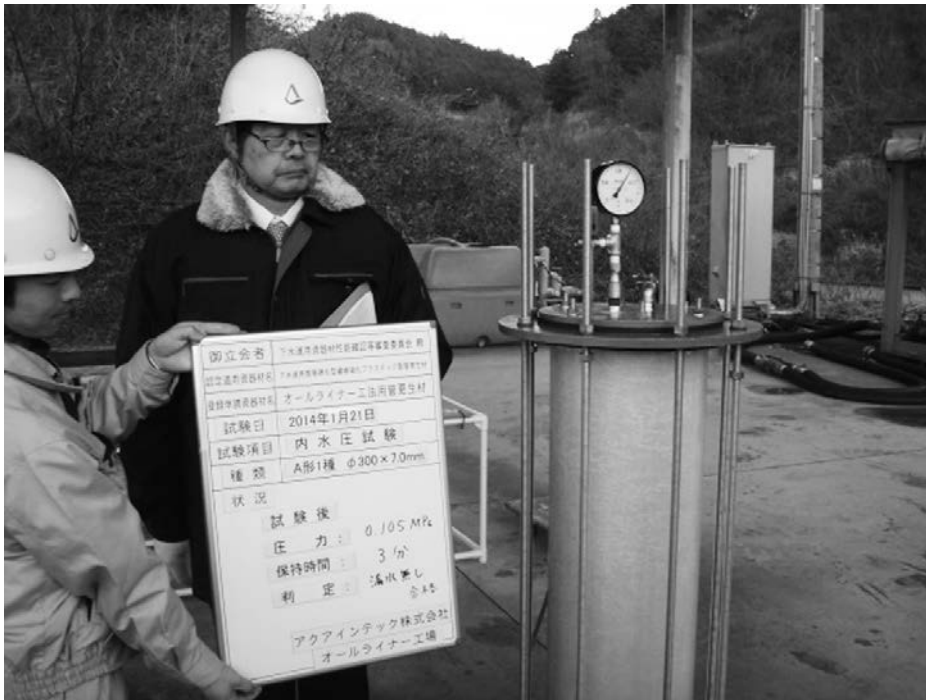
写真-2 性能確認試験立会(内水圧確認試験)
