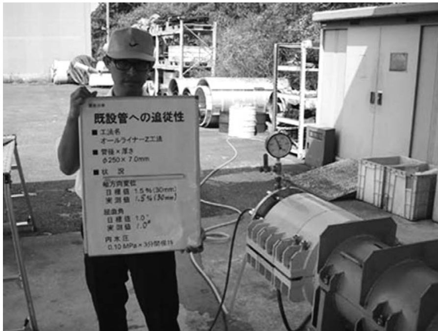
写真一4 立会試験（水密性確認）軸方向変位1.5%（30mm）、屈曲角1.0°、内水圧0.10MPa×3.0分保持漏水なし
