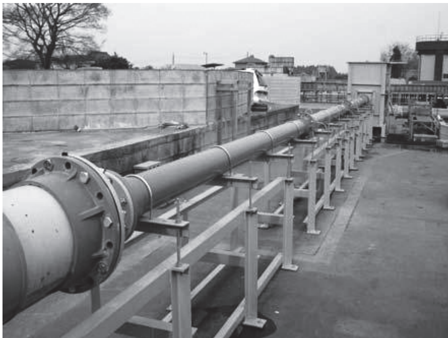
写真-2 サイドライナー工法に関する水理試験状況
